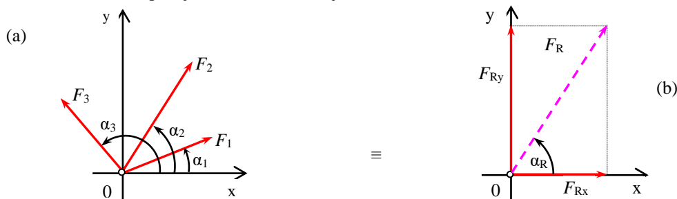
Slika 2.9. Analitički način određivanja rezultante konkurentnog skupa sila
