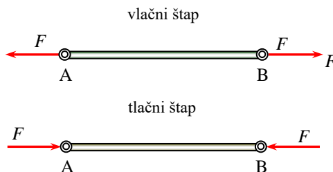
Slika 2.22. Štapovi mogu prenositi i vlačnu i tlačnu silu
