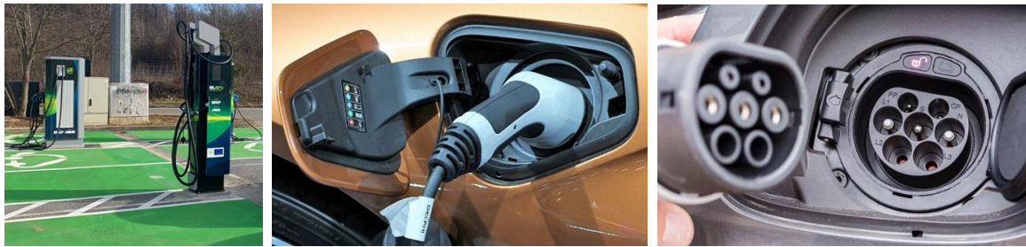
Slika 23: Punionica i priključak za punjenje EV, [26, 25, 27]
